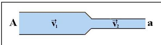
Le variabili del problema sono quattro: le pressioni e le velocità prima e dopo la strozzatura. Di queste, due sono note, fornite come dati del problema, due incognite. Per un problema a due incognite occorrono due equazioni: nel nostro caso, avendo a che fare con
